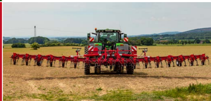
Легкое V-положение вследствие наклона крыльев
