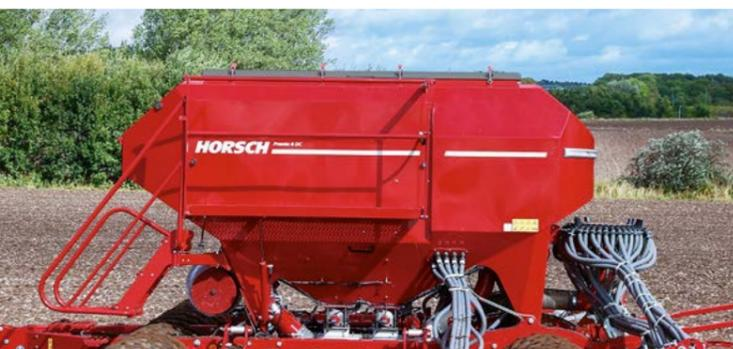
**2-секционный бункер большого объёма**
