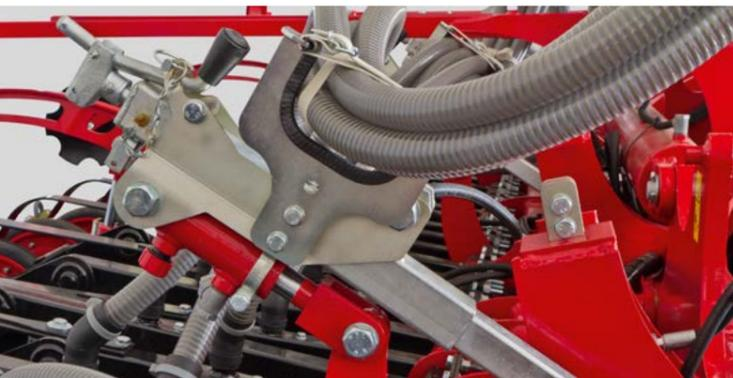
Опциональная гидравлическая регулировка давления на сошники
