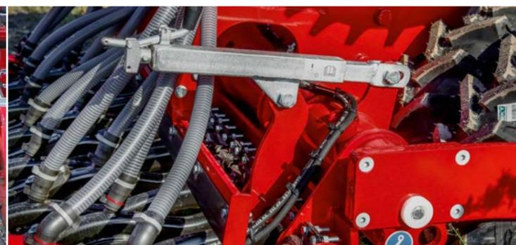
Бесступенчатая регулировка давления на сошники
