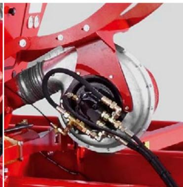
Вентилятор пневмосистемы с гидравлическим приводом
