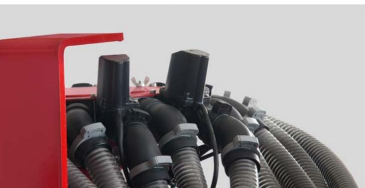
Электромагнитные клапаны технологической колес
