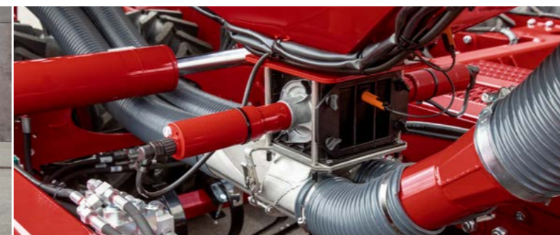
Двойные дозирующие катушки и распределители потока позволяют отключение и дифференцированное внесение материала половиной рабочей ширины машины.
