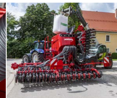
Одностороннее складывание Pronto 6 DC позволяет использовать для загрузки машины даже небольшой телескопический погрузчик
