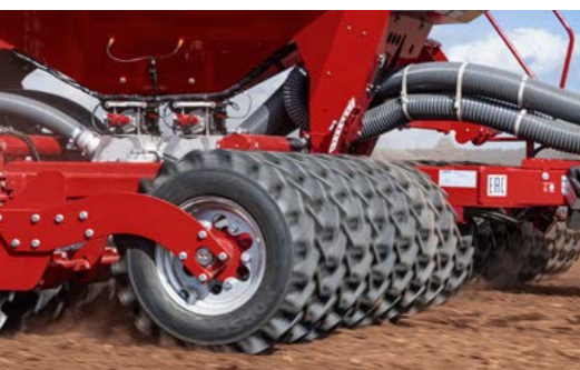
Опциональный передний почвоуплотнитель, использующий вес с задней оси трактора, служит для крошения крупных глыб и копирования микрорельефа поля.
