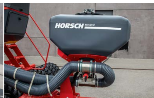
Хорошо знакомая MiniDrill G & F с PPF опцией позволяет одновременно дозировать 3 разных компонента
