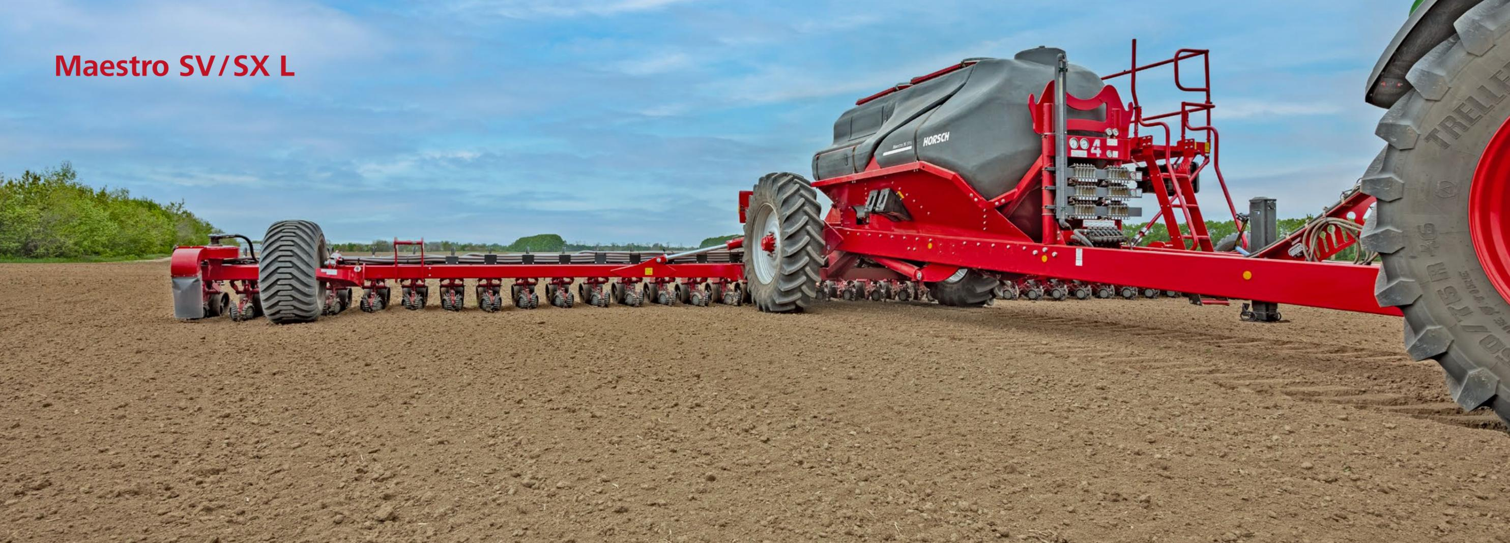
Новая **Maestro SV/SX L** создана на базе Maestro SV. Подача семян на все 24 секции выполняется из центрального бункера объемом 5 000 л. Бак для жидких удобрений также центральный и имеет объем 3 900 л. Центробежный насос мощностью 350 л/мин имеет широкий диапазон дозирования от 20 до 100 л/га при скорости до 15 км/ч. Удобрение может вноситься на выбор либо сразу в борозду рядом с выпадающими семенами, либо в еще открытую борозду сзади ролика-семяукладчика.
