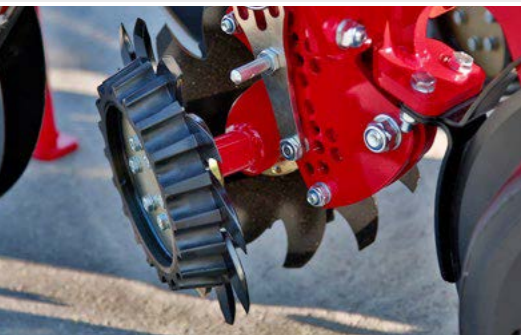
Опциональные бороздоочистители с плавающей подвеской и ведением по глубине.
