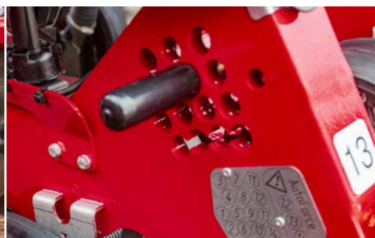
Кулиса с 14 отверстиями для регулирования глубины хода
