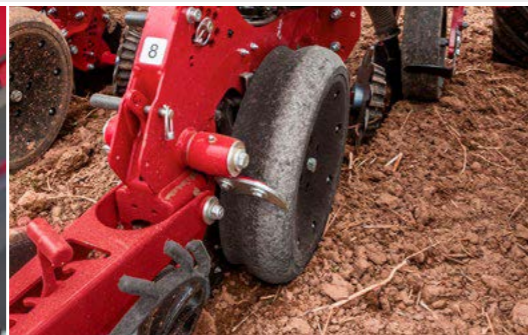
RID-ролик уменьшает уплотнение почвы рядом с бороздой в жестких условиях прямого посева.
