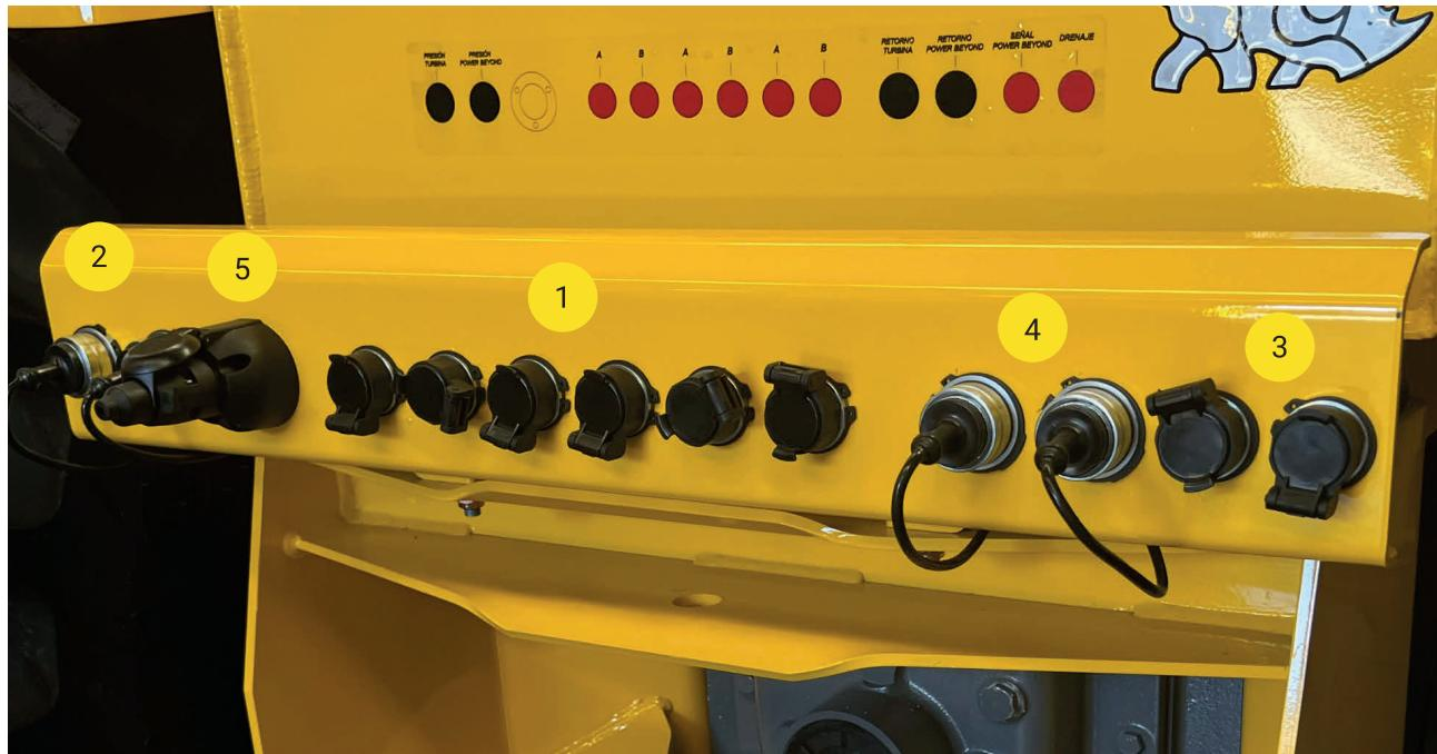
На серии Bravo установлены два гидравлических насоса с суммарной подачей порядка 320 л/мин. Один насос подает масло на три пары гидровыхходов и муфту PowerBeyond. Гидровыхходы обладают механическим управлением (одна пара с регулировкой по потоку). Второй насос (с электронным управлением) подает масло на вторую муфту PowerBeyond.
