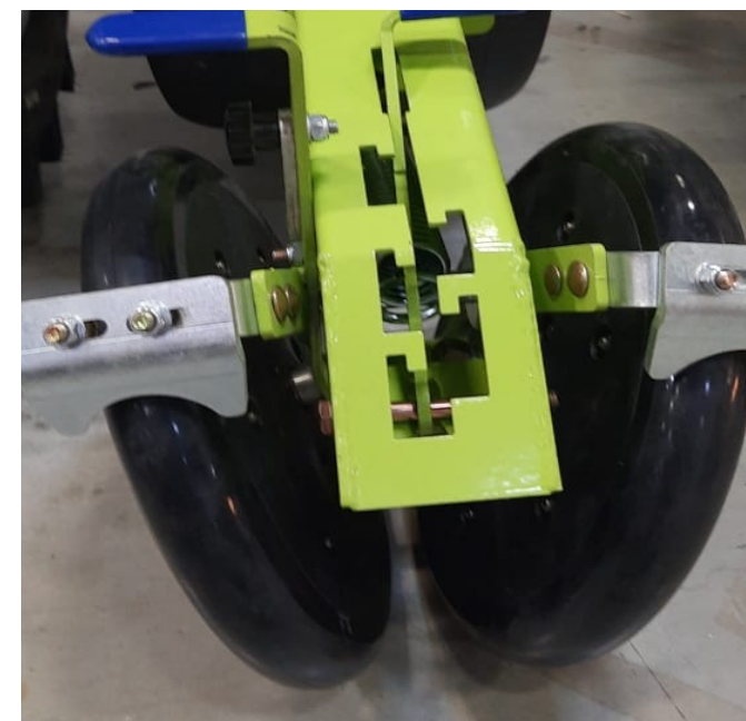
▲ V-образные резиновые колеса, с изменяющимся углом атаки
