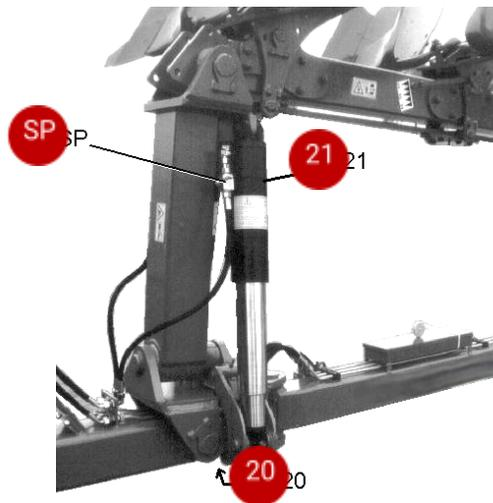
Перед транспортировкой следует перевести плужную балку в среднее положение, а затем закрыть запорные клапаны (SP) двух поворотных цилиндров (21).
