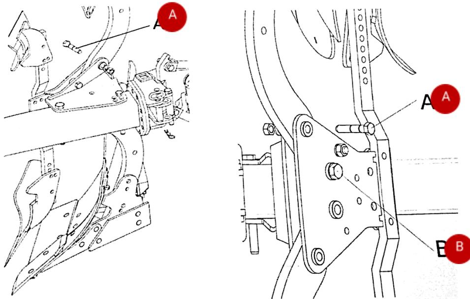
Предохранительный болт нужен, чтобы защитить основные конструктивные части плуга от повреждений при столкновении с камнями или корнями деревьев во время вспашки.
