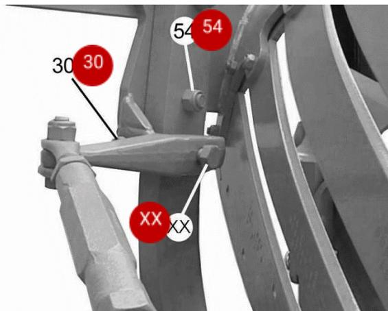
После регулировки необходимо затянуть регулировочный болт (30), болт крепления корпуса плуга (54) и зажимной болт (XX).
