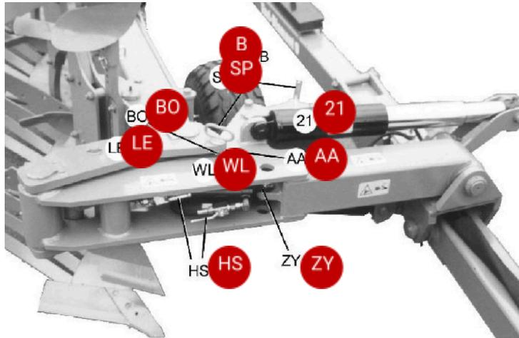
2. Откройте запорный клапан (HS) гидравлического цилиндра (ZY).
