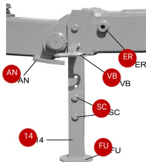
Сначала присоедините отвал к трактору. Затем, подняв поворотную опору, опустите раму поворотного плуга (7), чтобы ось рельса была параллельна земле.
