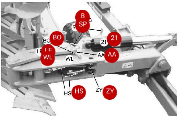
5. Манипулируя контроллером рамы поворотного плуга, полностью разверните гидравлический цилиндр (ZY). Полунавесной поворотный плуг можно отрегулировать в рабочее положение на берегу.
