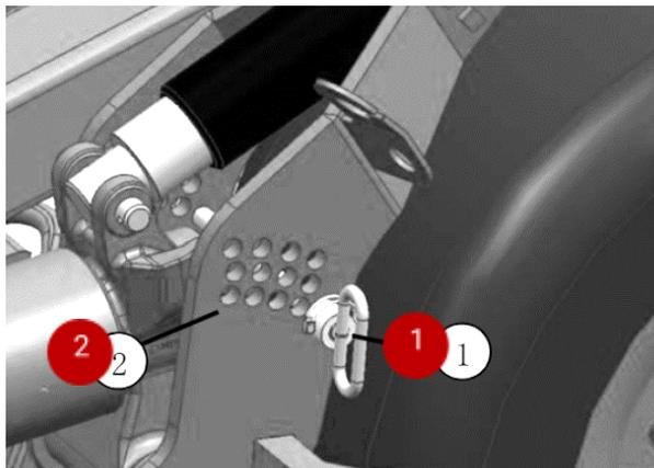
После завершения регулировки штифт вставляется на место и фиксируется предохранительным кольцом и стопорным штифтом.
