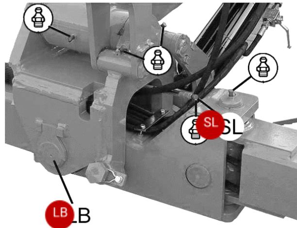
Опорные трубки болтов (LB) смазываются маслёнками (SL) со смазочными ниппелями.
