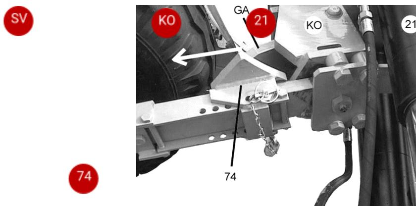
Если плуг находится в режиме «в борозде», переднее колесо нужно поставить на середину (74) и зафиксировать. Для этого упор нужно переместить вверх, пока фланец (NA) опорного кронштейна (KO) не войдёт в отверстие упора (AU)
