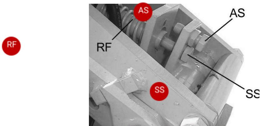
Если опорное колесо не доходит до ограничителя, поверните регулировочный винт (SS) против часовой стрелки, чтобы уменьшить усилие возвратной пружины.
