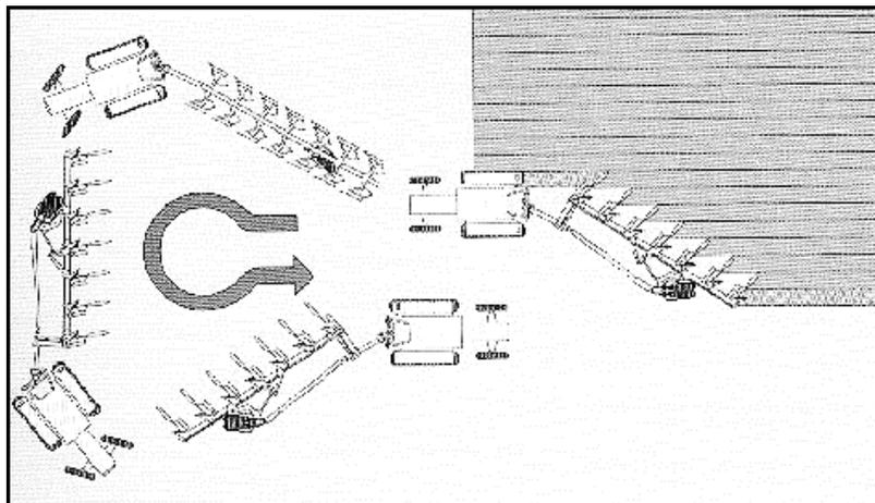
Чтобы развернуться на поле, нужно повернуть брус плуга приблизительно на 120–135 градусов, управляя плужным колесом. После этого трактор одновременно разворачивается на невспаханное поле, образуя круговую колею. При входе на следующую борозду поворотный плуг необходимо настроить на противоположную сторону трактора.
