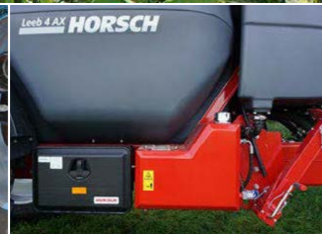
Автономная гидравлическая система AX не зависит от гидравлики трактора.
