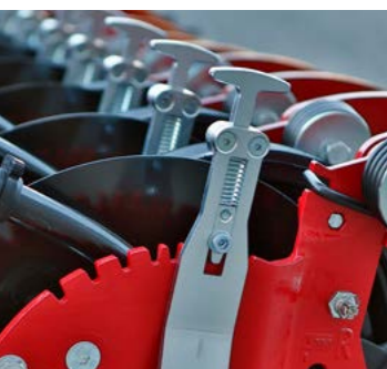
Тонкая регулировка глубины посева без специнструментов
