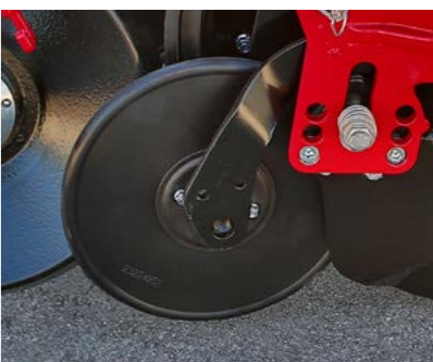
Прикатывающий ролик обеспечивает плотный контакт семян с почвой
