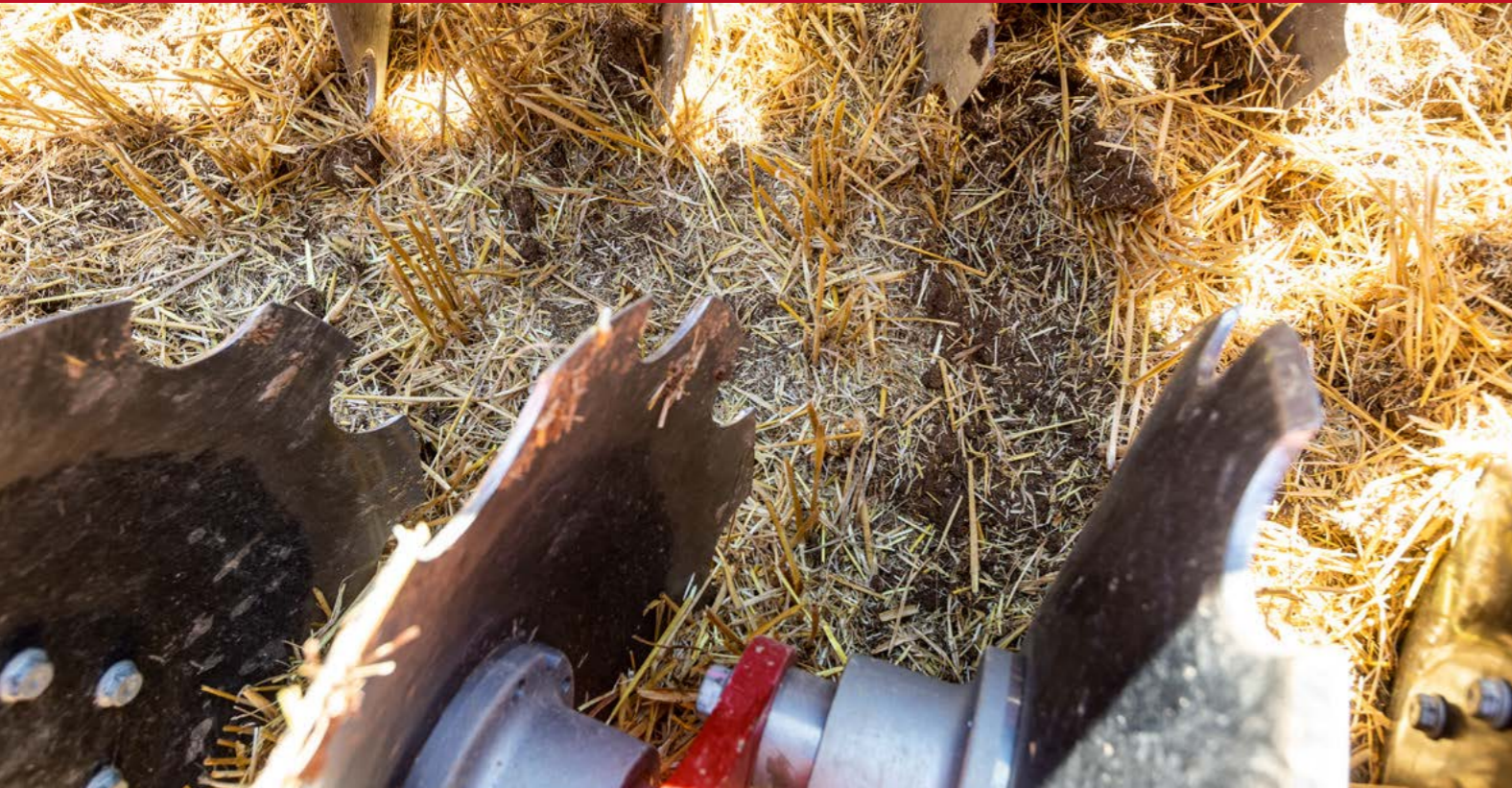
Широкие кронштейны крепления стоек с резиновыми демпферами для неизменно высокого качества обработки в любых по сложности условиях.
