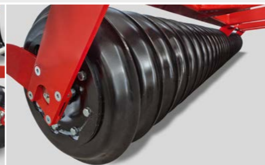
Закрытый каток SteelDisc для дополнительного крошения
