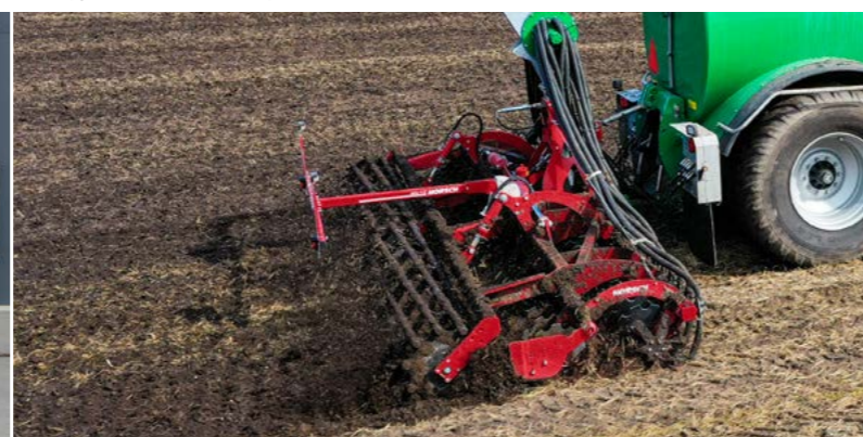
Joker CT с комплектом для внесения жидкой органики и прутковым катком
