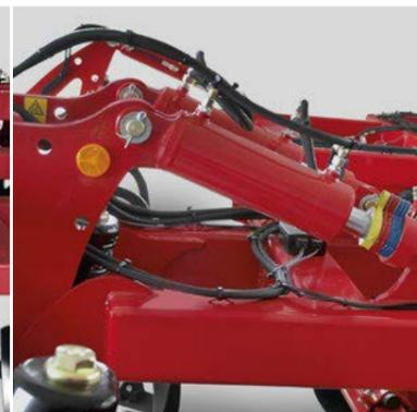
Регулирование глубины обработки: Путем ограничения хода штоков гидроцилиндров посредством удобных алюминиевых упоров AluClips
