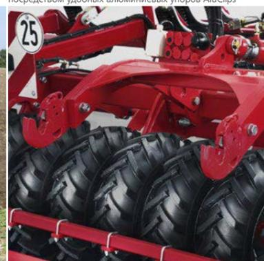
Задняя навеска на раме с разъёмами гидро и электросистем
