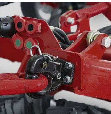
Задний фаркоп с местами подключения разъемов гидро- и электросистем
