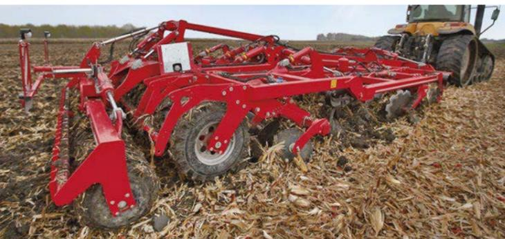
Шинный почвоуплотнитель в комбинации со стальным катком SteelDisc (опция)
