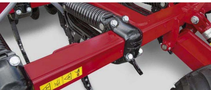
Стойки TerraGrip с защитой до 770 кг
