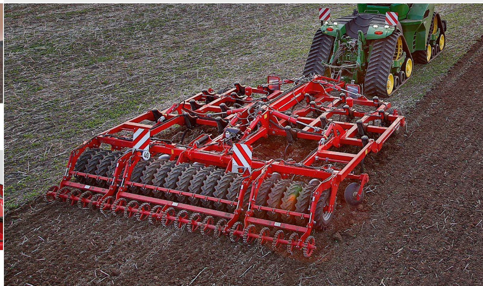
Обратное уплотнение: колесный каток с большой площадью опоры и равномерным по глубине уплотнением с опциональным катком TopRing для дополнительного крошения
