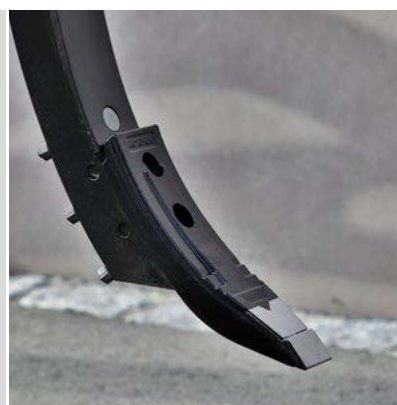
Усиленный наконечник стойки MulchMix HM+
