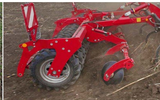
Выравнивающие диски Равномерное выравнивание перед колёсным почвоуплотнителем
