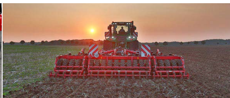
Обратное уплотнение: колесный каток с большой площадью опоры и равномерным по глубине уплотнением с опциональным катком TopRing для дополнительного крошения
