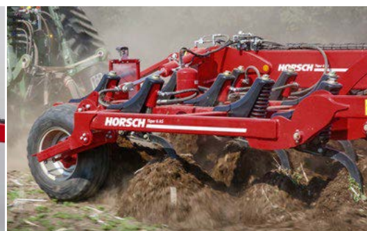
Гидравлическая защита стоек TerraGrip с усилием срабатывания более 770 кг (опционально для 1-го и 2-го ряда стоек Tiger 5, 6, 8 AS)
