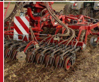
Модуль с сошниками TurboDisc Ширина междурядий 15 см, интегрированная амортизация, бесступенчатое регулирование давления до 120 кг/сошник
