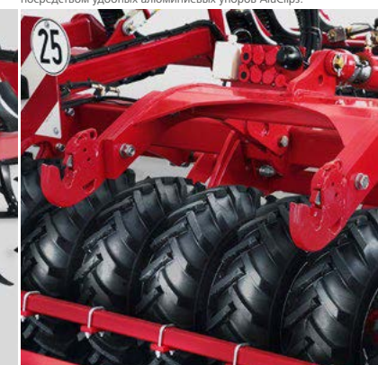
Задняя навеска на раме с разъёмами гидро и электросистем
