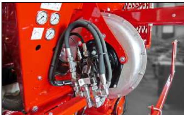
Двигатель воздуходувки, прямой привод
