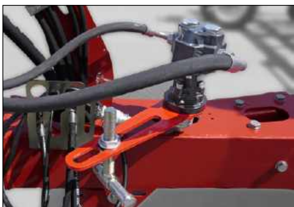
Насос с приводом от вала отбора мощности в парковочном положении.
