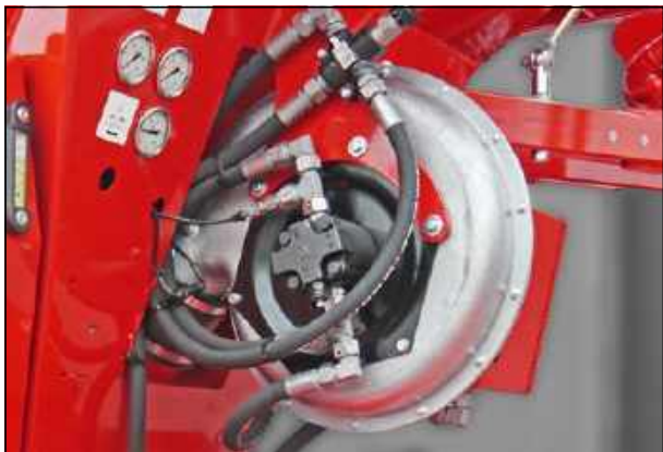
Двигатель воздуходувки с приводом от вала отбора мощности
