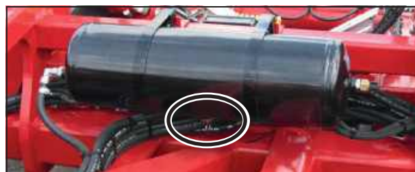
Воздушный ресивер с клапаном удаления воды
