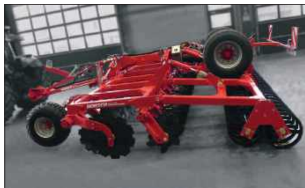
Цилиндры почвоуплотнителя и шасси втянуты
