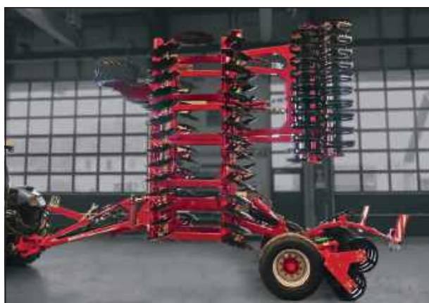
Цилиндры почвоуплотнителя и шасси выдвинуты
