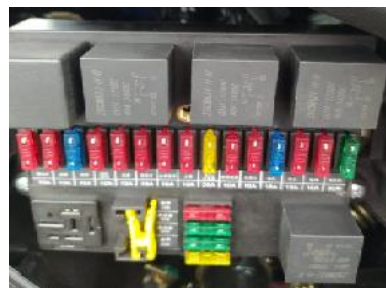
Рис. 2-77. Центральный коммутационный блок
