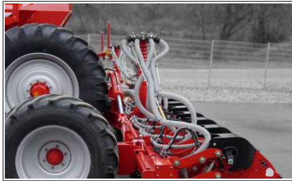
Башня распределителя с шлангопроводами системы внесения удобрений
