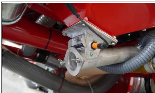
Бункер заперт, дозирующий шнек извлечен
