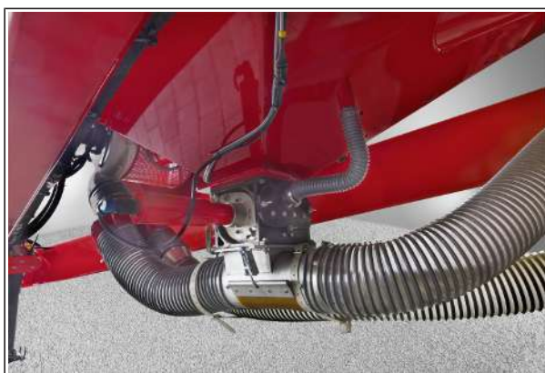
Дозатор со спускным шлюзом
