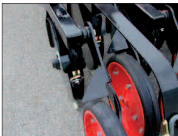
Скребки дисков лемеха и уплотняющие ролики
