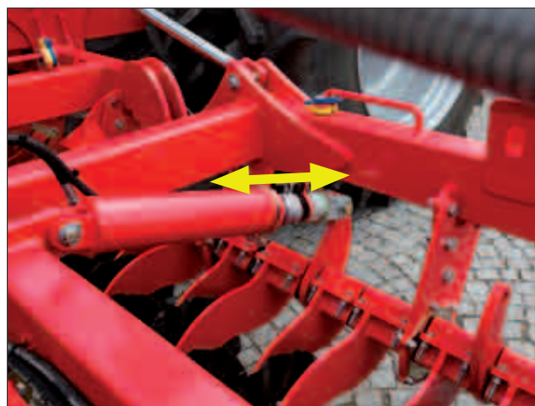
Гидравлический цилиндр системы регулирования глубины с алюминиевыми фиксаторами
