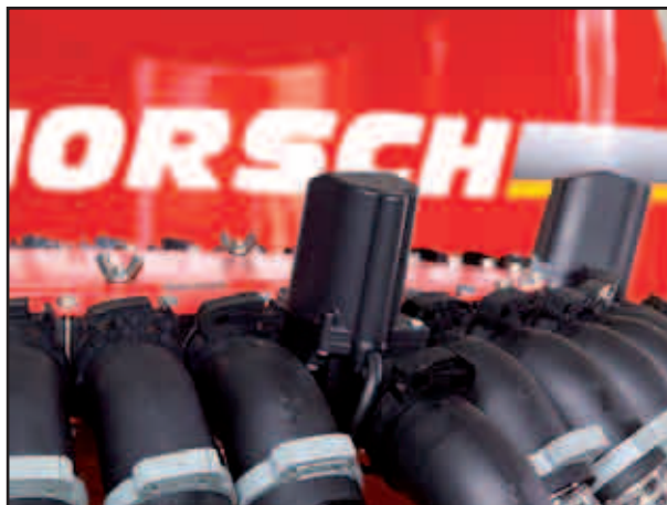
Заслонки с моторным приводом системы управления высевом по технологическим дорожкам
