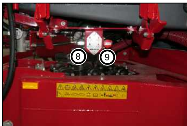
Кнопка управления для отпуска пневматического тормоза
