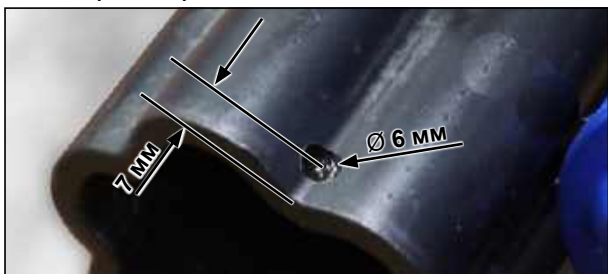
Размер отверстий для крепления уплотнительного кольца
