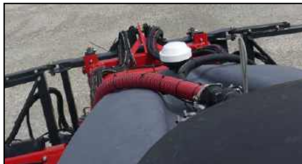
Приемник GPS, смонтированный на бак для эмульсии
