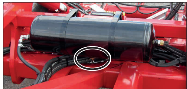
Воздушный ресивер с клапаном удаления воды
