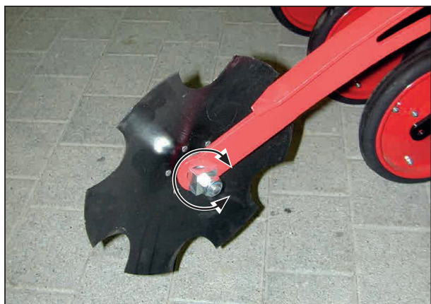
Предвсходовой разметчик - регулировка чувствительности диска
