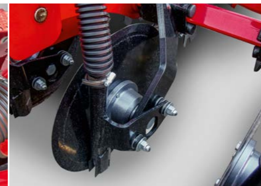
Туковые сошники PPF Необслуживаемые подшипники, высокое давление на сошник
