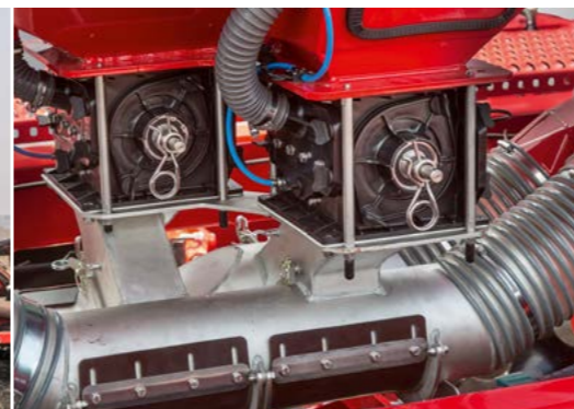
Двойной шлюз для объединения доз туков в один поток
