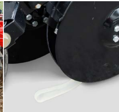
Пластиковый распределитель (семян) и скребок Гарантированный посев даже при влажных условиях
