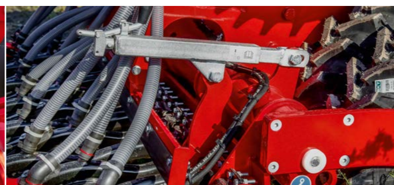
Бесступенчатая регулировка давления на сошники посредством мануальной регулировки изменяется степень натяжения резиновых элементов
