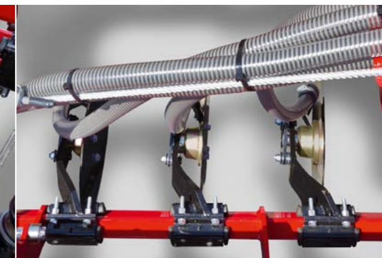
Регулируемая настройка рабочей глубины Внесение удобрений между двумя рядами посевов по центру колеса почвоуплотнителя
