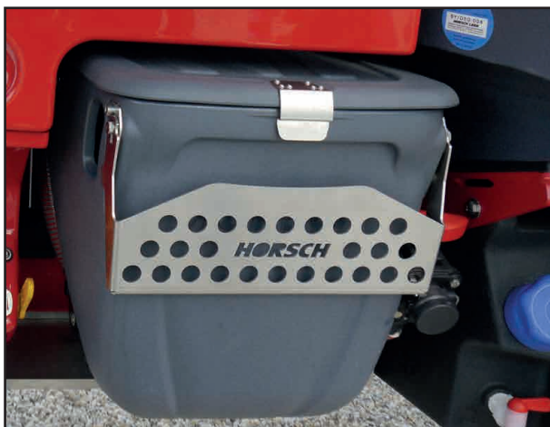
Опционально: Станция для заправки пестицидов с воронкой из высококачественной стали
