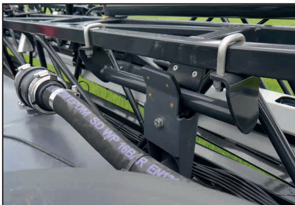
Место укладки штанги внутреннего крыла
