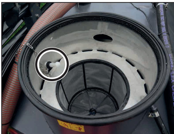
Сопла очистки верхней части
