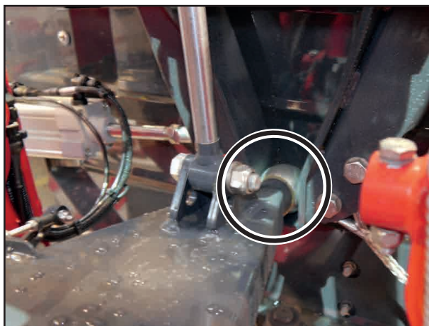
Выравнивание на склоне заблокировано
