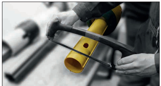
Внутренняя защитная труба
