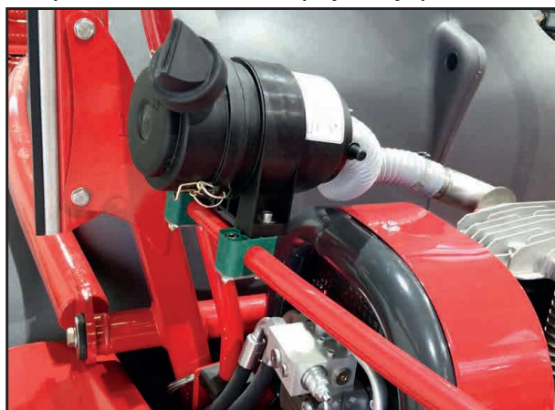
Фильтр всасываемого воздуха
