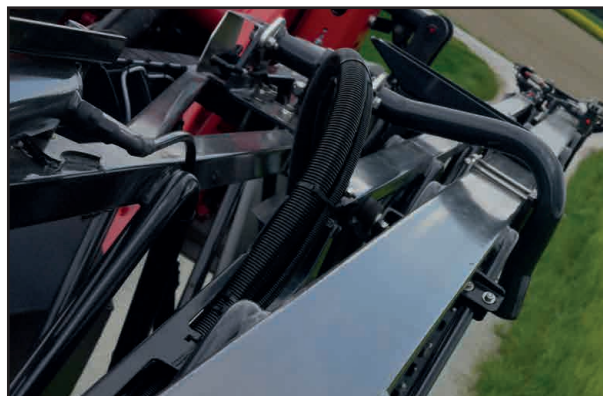
Блокировка штанги закрыта
