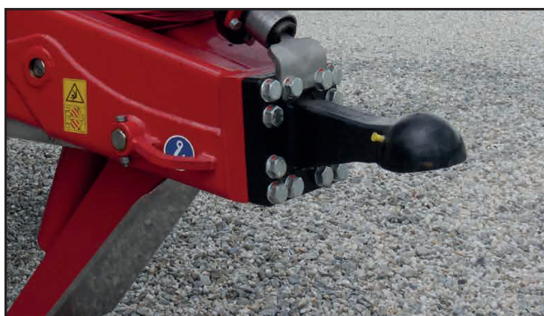
Сцепка за шаровую головку
