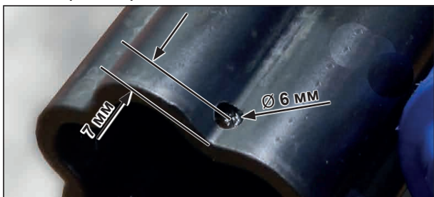
Размер отверстий для крепления уплотнительного кольца
