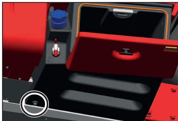
Запорный винт бачка рукомойника
