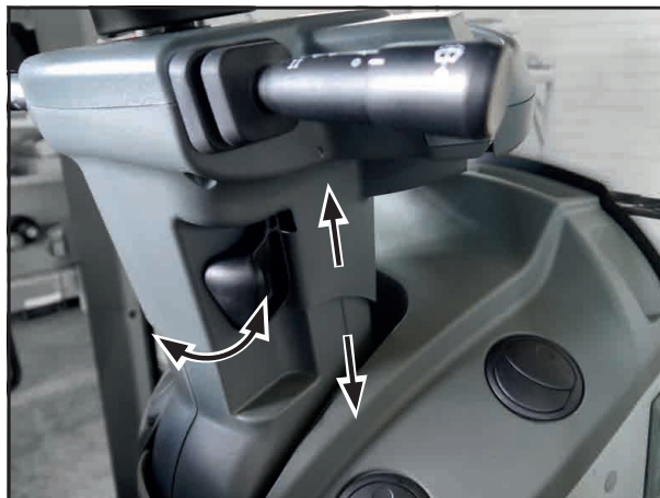
Регулировка рулевой колонки по высоте
