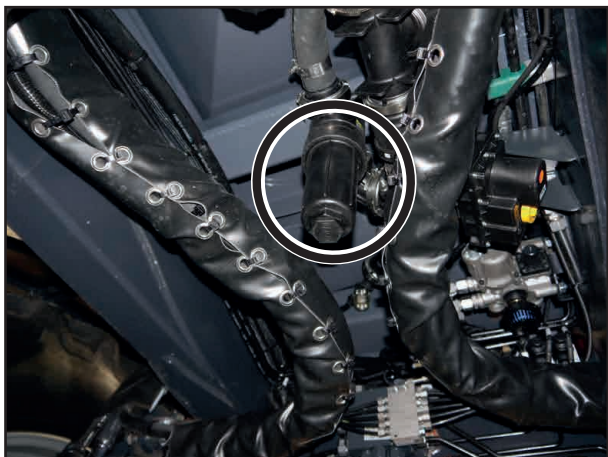
Всасывающий фильтр, мембранно-поршневой насос
