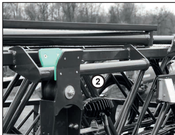
Укладка штанги (2) в положении для хранения (транспортное положение)
