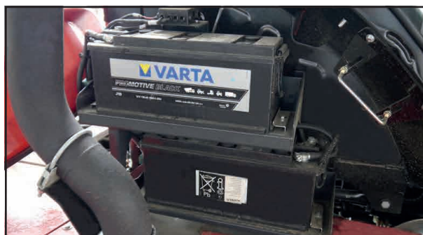
Бортовая сеть 24 В за правой обшивкой кабины
