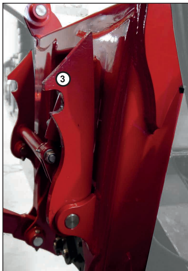
Блокировка параллелограмма (3) открыта
