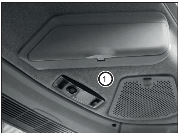
Консоль крыши слева (1) с отсеком для принадлежностей и потолочным освещением
