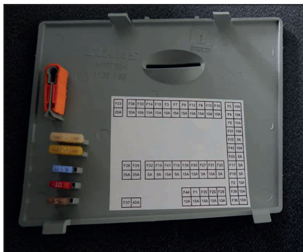
Крышка блока предохранителей с запасными предохранителями
