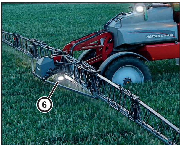
NightLight (6) при эксплуатации в поле
