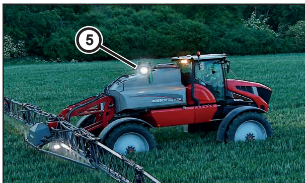
Фары рабочего освещения сзади (5) при эксплуатации в поле
