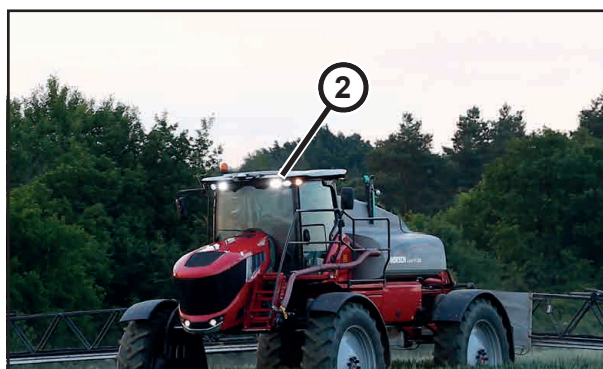
Фары рабочего освещения спереди (2) при эксплуатации в поле
