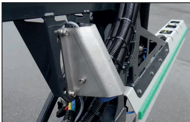
Ультразвуковой датчик на штанге
