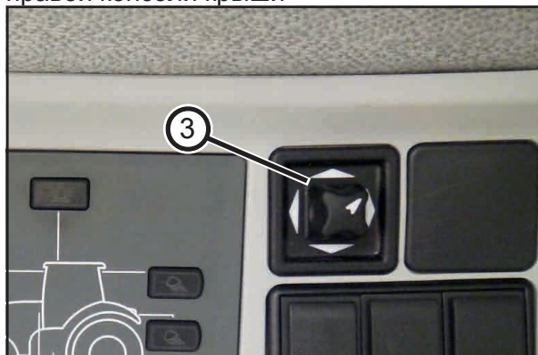
Управляющий переключатель регулировки наружных зеркал (3)
