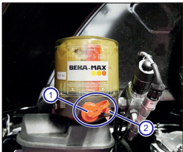
Насос централизованной системы смазки
