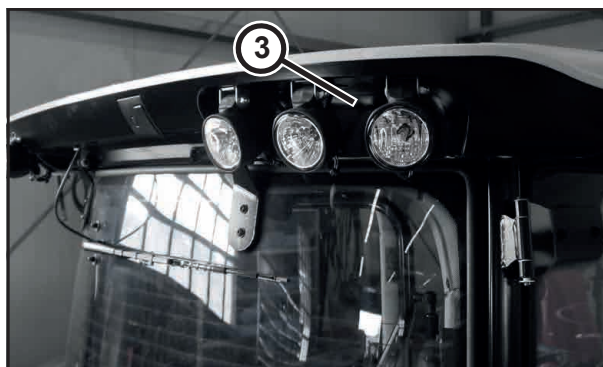
Фары сзади (3) (только для выполнения ремонтных работ)
