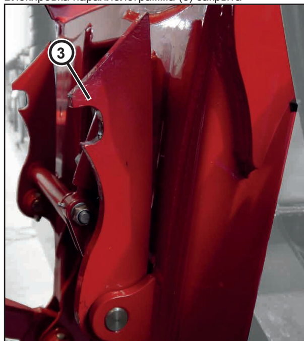
Блокировка параллелограмма (3) открыта
