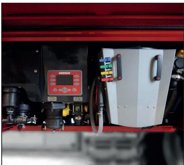
Внешний терминал управления и станция для заправки пестицидов
