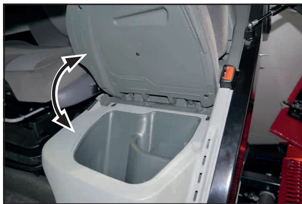
Отсек для принадлежностей с встроенной системой охлаждения под сиденьем сигнальщика.
