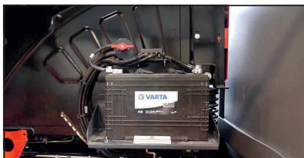
Бортовая сеть 12 В за левой обшивкой кабины
