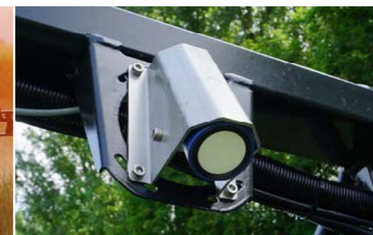
Дополнительное оснащение еще двумя ультразвуковыми датчиками
