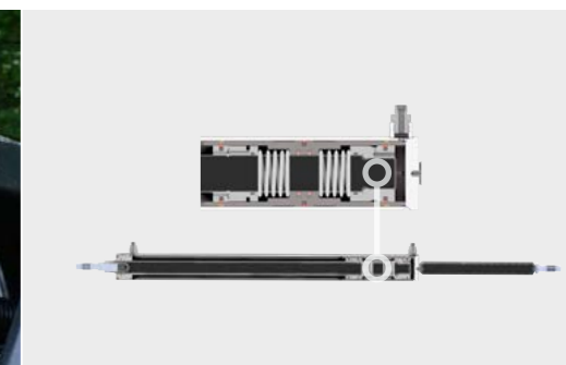
MotionControl для амортизации горизонтальных колебаний крыльев штанги
