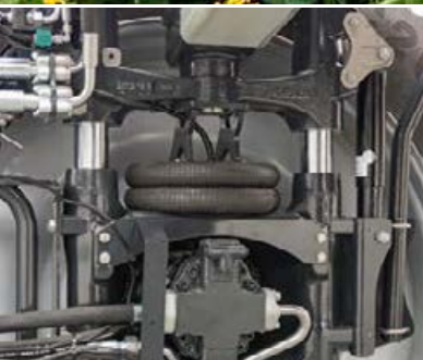
Индивидуальная подвеска колес на подвижной раме
