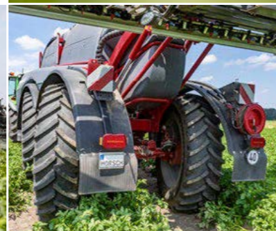
Высокий рабочий просвет и гладкое днище машины, поддресоренная ось, опционально с пневмоподвеской.
