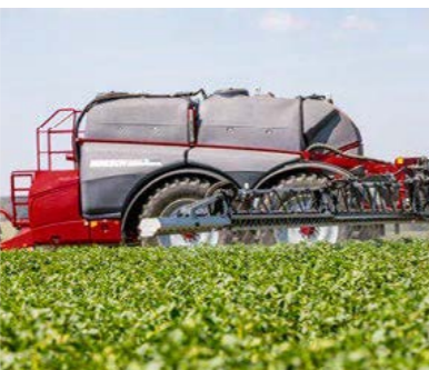
Двойной бак для оптимального распределения нагрузки
