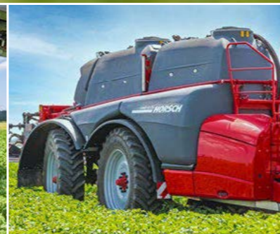
Тандемная ось с функцией копирования и поворотом всех четырех колес
