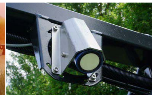
Дополнительное оснащение еще двумя ультразвуковыми датчиками
