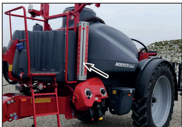
Механический индикатор уровня заполнения
