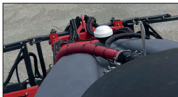
Приемник GPS, смонтированный на бак для эмульсии
