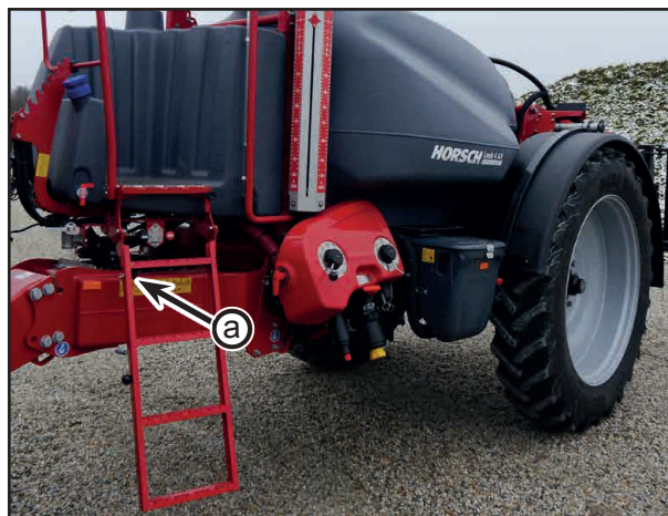
Откидная подножка - стопорный палец с пружинной нагрузкой (a)
