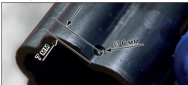
Размер отверстий для крепления уплотнительного кольца
