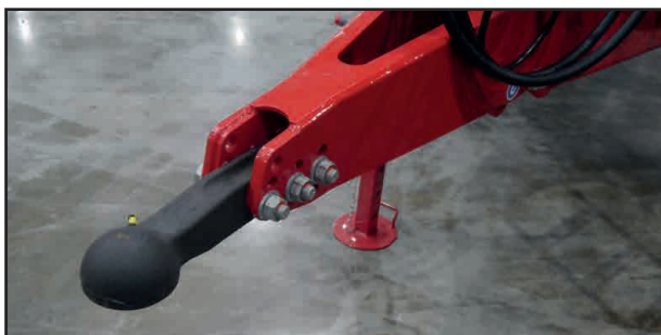
Сцепка за шаровую головку
