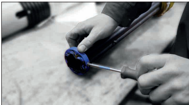
Закрепление уплотнительного кольца
