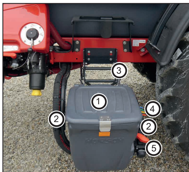
Станция для заправки пестицидов с пластмассовой воронкой
