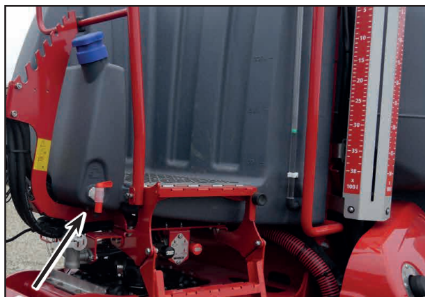
Запорный винт бачка ручейника
