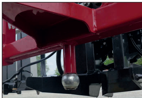
Выравнивание на склоне деблокировано
