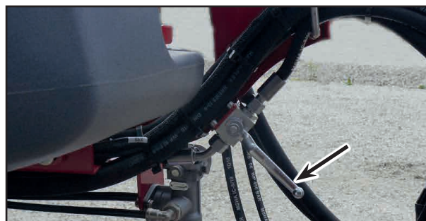
Положение запорного клапана при движении по дорогам
