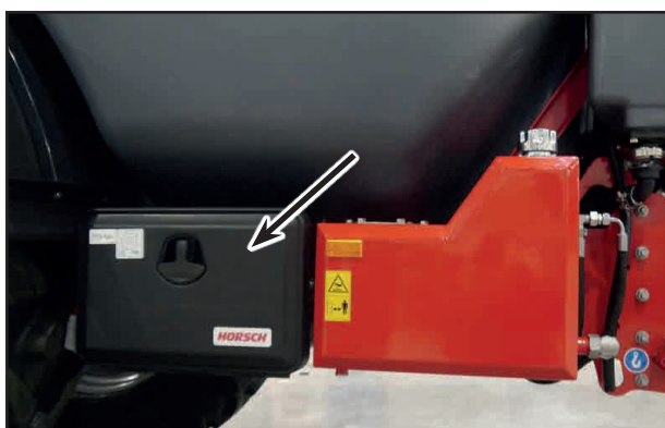
Отсек для транспортировочных принадлежностей на правой стороне машины
