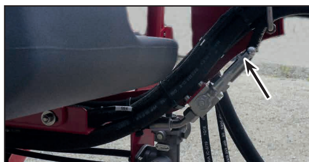
Положение запорного клапана при движении по полю
