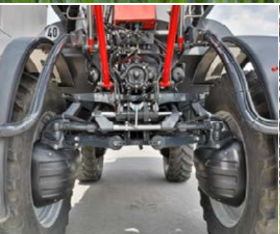
Защита днища с интегрированными кожухами для приводов колес не травмирует растения
