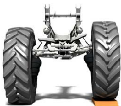
Автоматическое регулирование уровня: индивидуальная амортизация каждого колеса с активной компенсацией.
