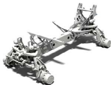
Шасси ComfortDrive: комфортное движение благодаря индивидуальной подвеске всех четырех колес; легкая и стабильная конструкция.
