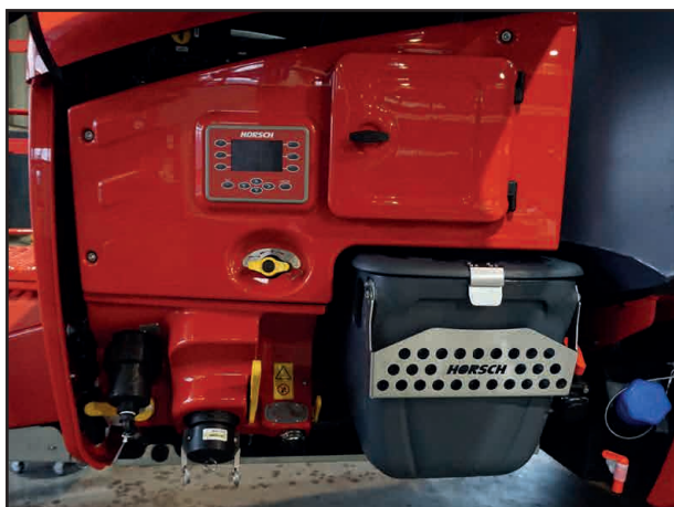
Внешний терминал управления, загрузочные патрубки и станция для заправки пестицидов
