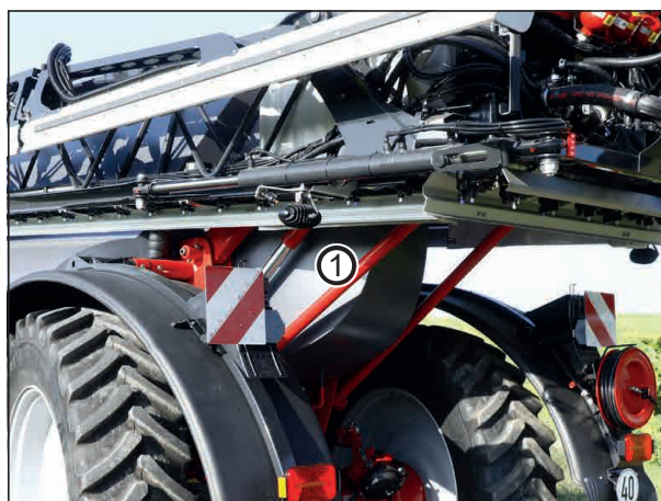
Бак чистой воды
