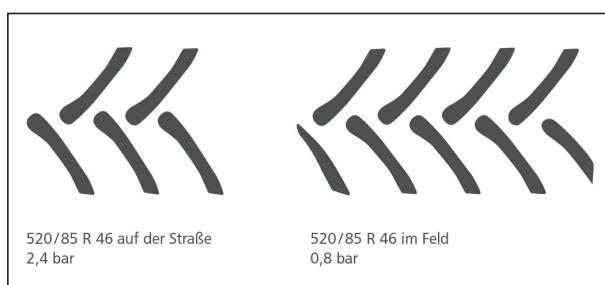
Поверхность контакта шин в зависимости от давления в шинах
