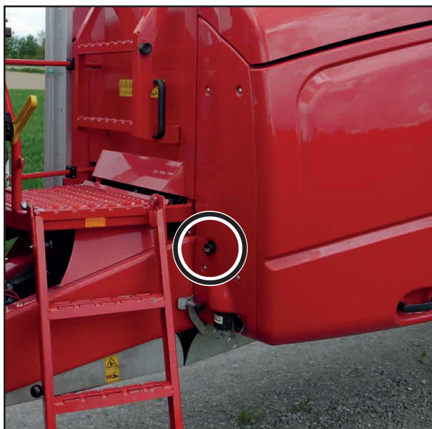
Кнопка управления для отпускания пневматического тормоза
