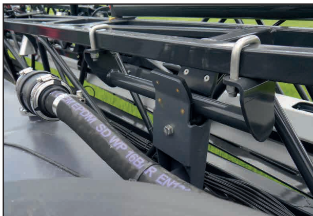
Место укладки штанги, внутреннее крыло
