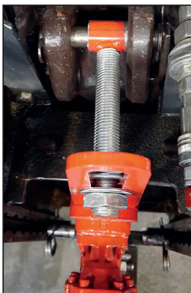
Насос с приводом от вала отбора мощности на тягаче
