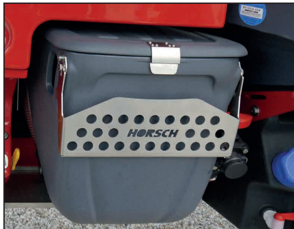
Отсек для хранения станции для заправки пестицидов с воронкой из высококачественной стали
