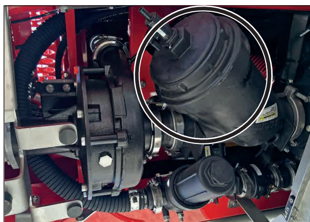
Всасывающий фильтр, центробежный насос
