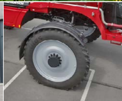
Большие колеса диаметром до 2,19 м.
