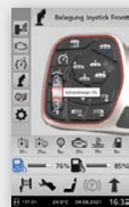
Функции программируемых кнопок джойстика на ErgoControl консоли можно удобно задать через дисплей машины
