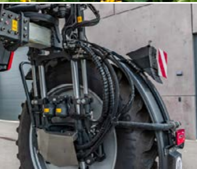
Индивидуальная подвеска колес на подвижной раме
