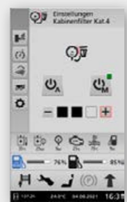
Возможности настройки режима работы фильтра кабины Kat. IV: автоматический/ручной с разной интенсивностью
