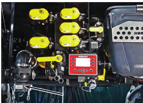
Патрубок с заглушкой, водяная система Basic Pro и CCS Pro
