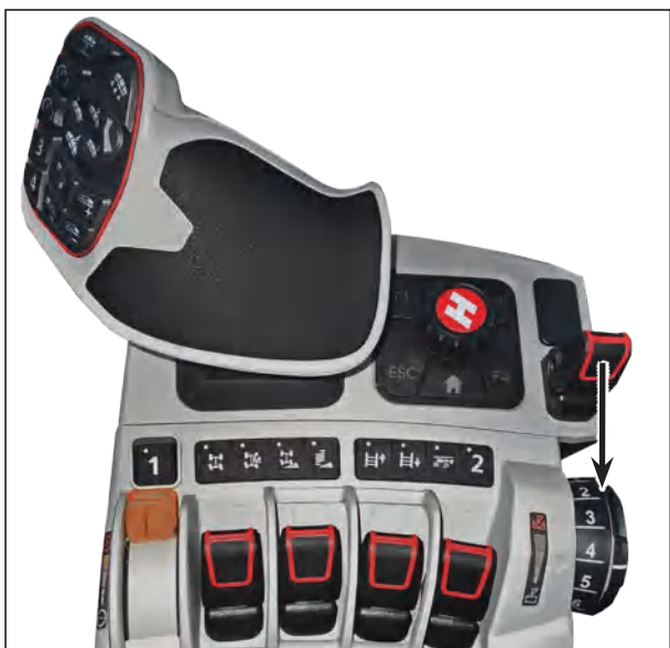
Переключатель для выбора направления движения
