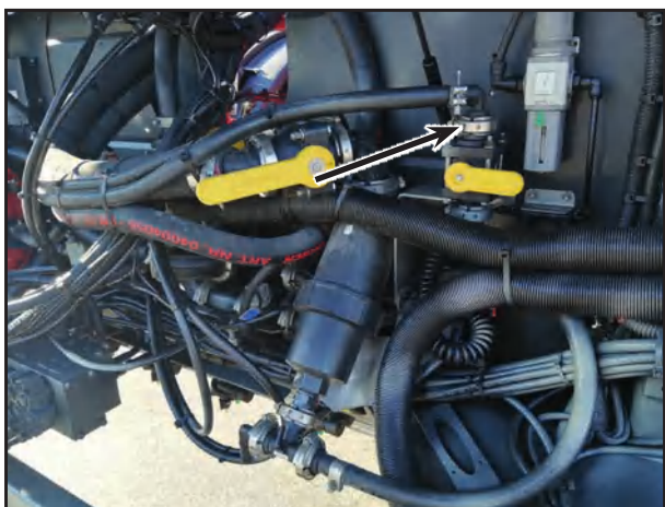
Отделитель воды и комбинация из фильтра и регулятора
