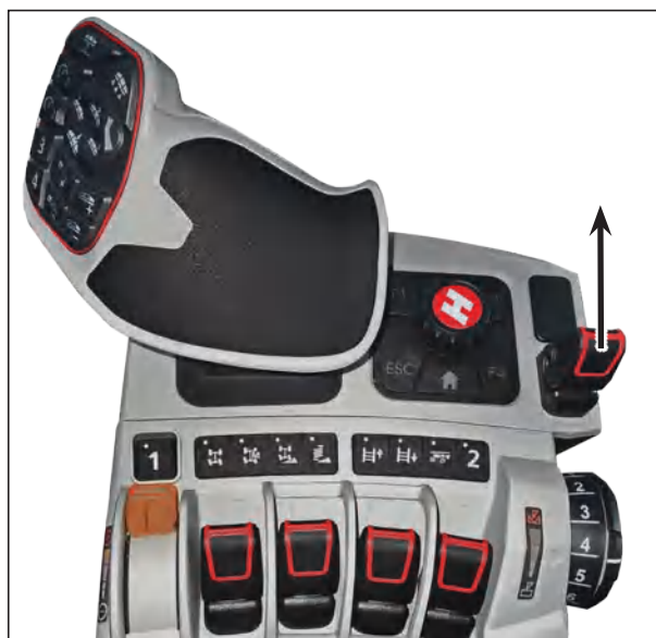
Переключатель для выбора направления движения
