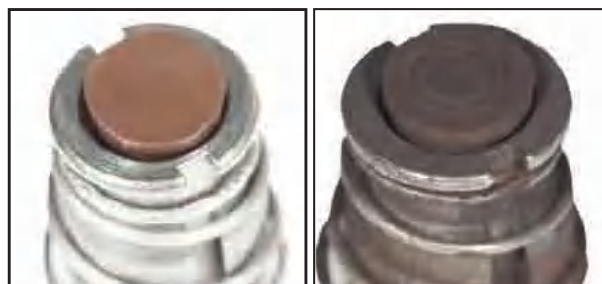
Золотник клапана (5) новый (слева), изношенный (справа)
