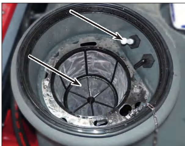
Сито горловины и форсунка для очистки горловины
