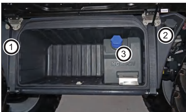
Топливный бак (на изображении представлен вариант с двигателем с нормой Stage V и баком для раствора карбамида)
