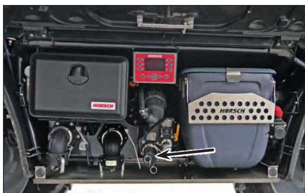
Штуцер для сброса давления (изображение различается в зависимости от типа машины)
