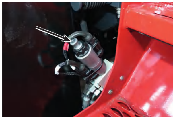
Клапан для механического отпуска лестницы
