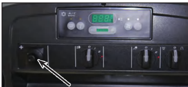
Переключатель для регулировки наружных зеркал
