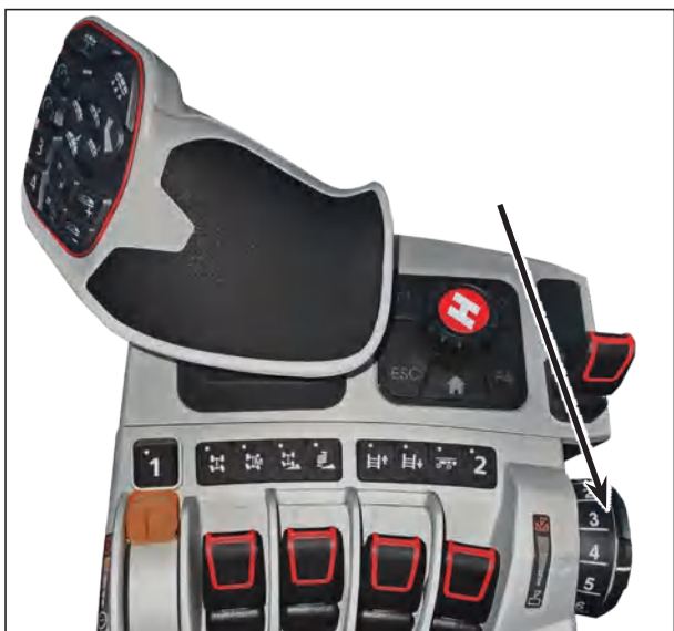
Ручная правка для сдувания на склоне
