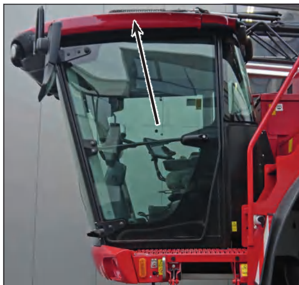
Положение фильтра из активированного угля
