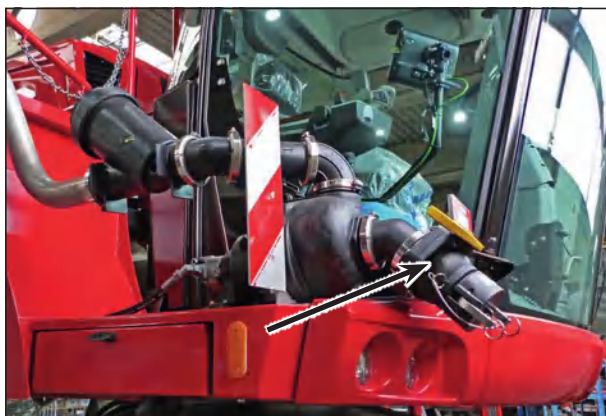
Патрубок для прямого наполнения с помощью насоса и фильтра (опционально)
