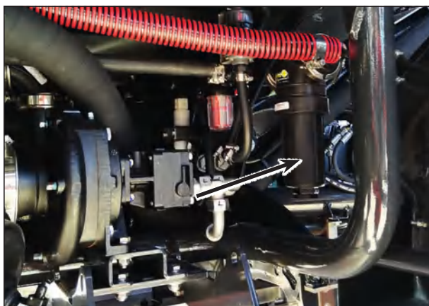
Всасывающий фильтр, очищающий насос
