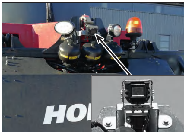
Камера заднего хода в средней секции штанги
