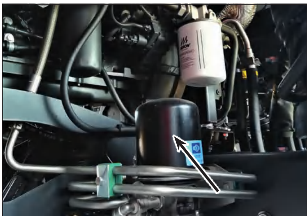
Осушительный патрон пневматической системы
