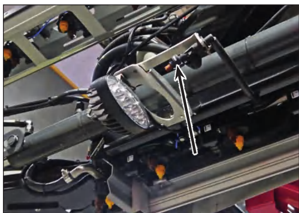
NightLight с форсунками очистного устройства (примерное изображение)
