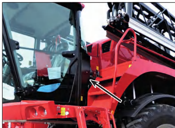
Механическое приспособление для отпуска лестницы
