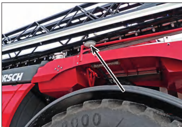
11 Освещение зоны перед штангой (по одному узлу на правой и левой части) (опционально)
