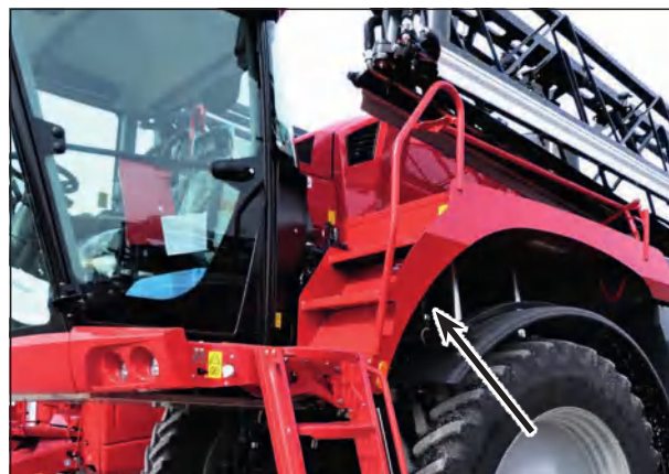
Положение осушительного патрона пневматической системы
