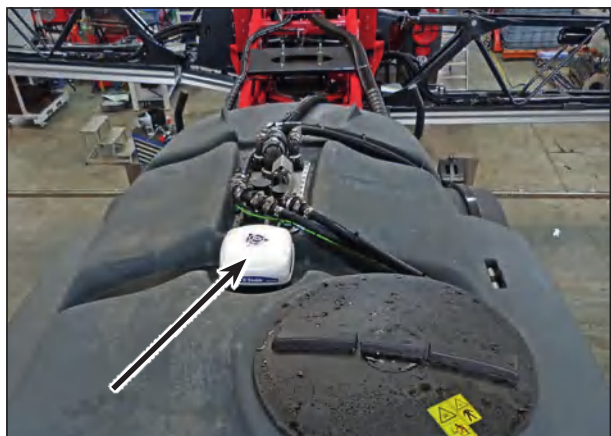
Приемник GPS, смонтированный на баке эмульсии
