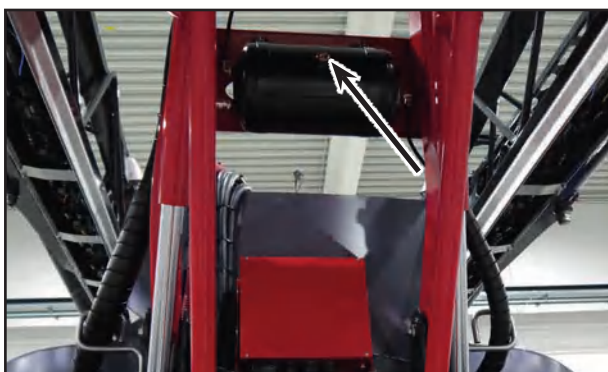
Резервуар для сжатого воздуха в параллелограмме с клапаном для слива конденсата
