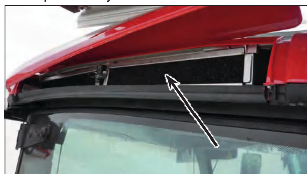
Фильтры из активированного угля с корзинчатыми фильтрами
