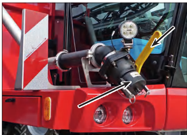
Патрубок для прямой заправки (правая сторона машины, фильтр опционально)
