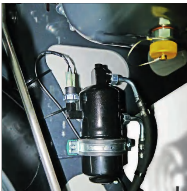
Осушительный патрон под масляной ванной
