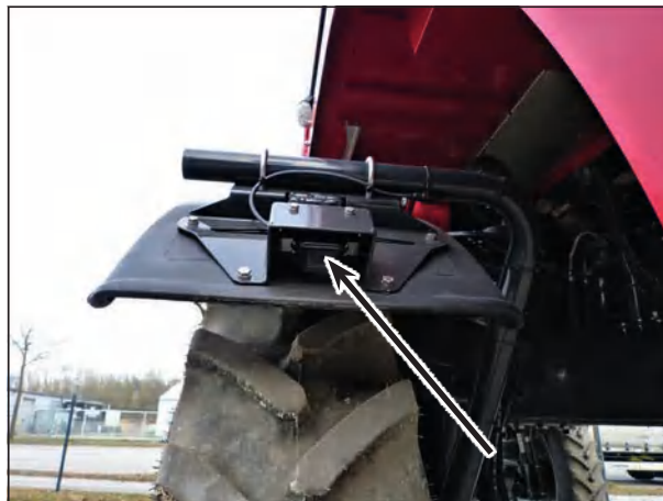
Камера колеса на крыле правого переднего колеса
