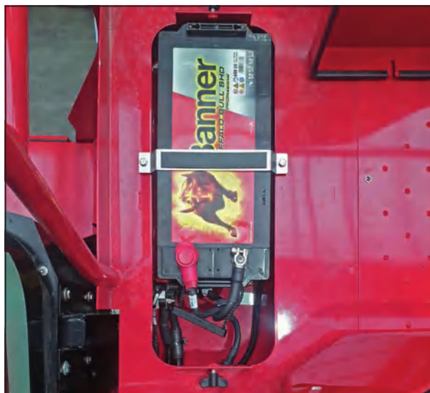
Бортовая сеть 12 В (справа за кабиной)
