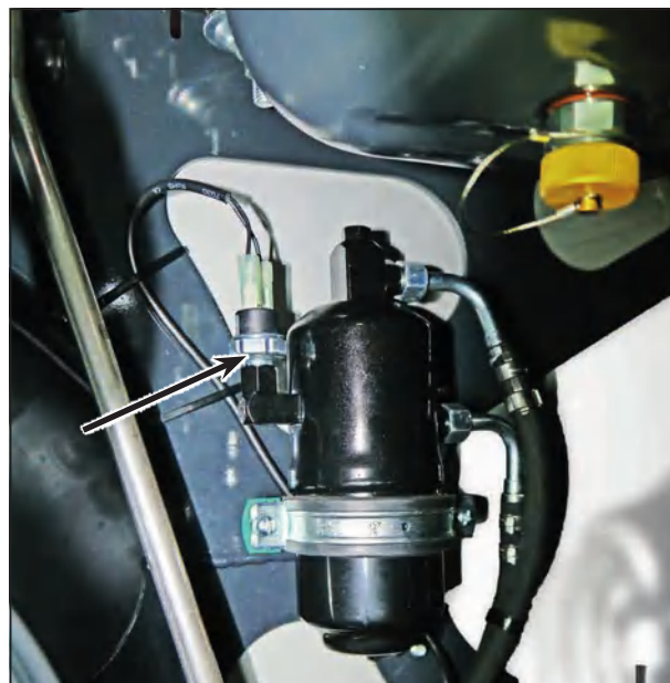
Манометрический выключатель осушительного патрона
