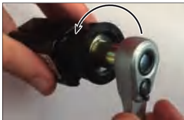
Открывание переключающих клапанов форсунок
