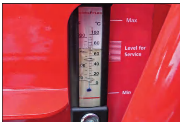
Смотровой глазок бака для гидравлического масла
