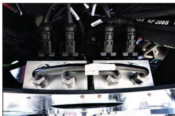
Механическое приспособление для отпуска TrackControl передней оси
