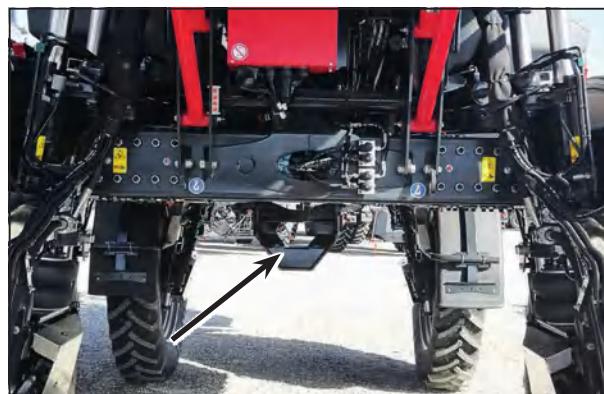
Позиция подъемного устройства при поставке
