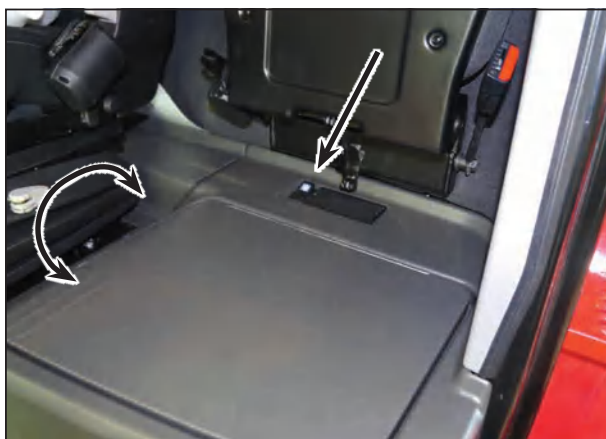
Отсек для принадлежностей с встроенной системой охлаждения под сиденьем сигнальщика.
