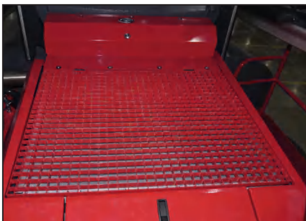
Сетчатый фильтр из нержавеющей стали и решетка подножки
