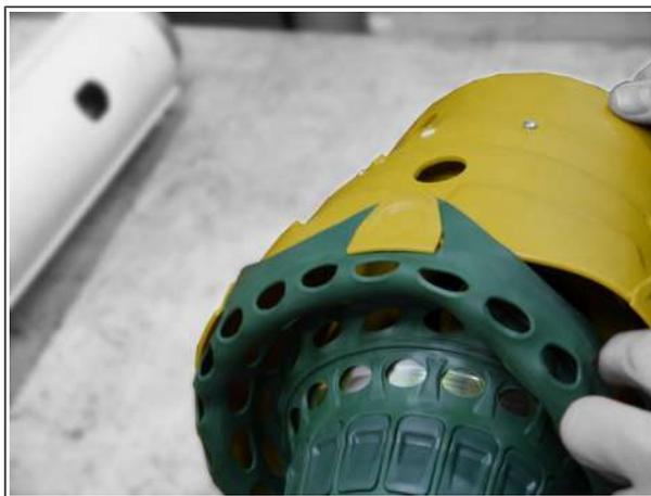
20. Смажьте наружную поверхность внутренней защитной трубы.
