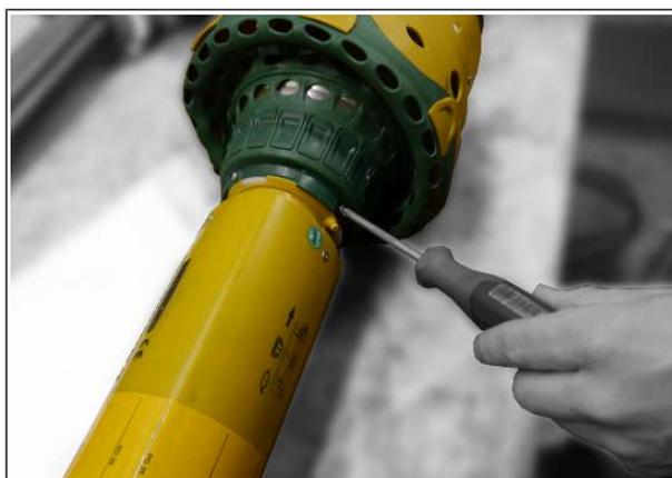
5. Отсоедините эластичный элемент подходящим инструментом:
