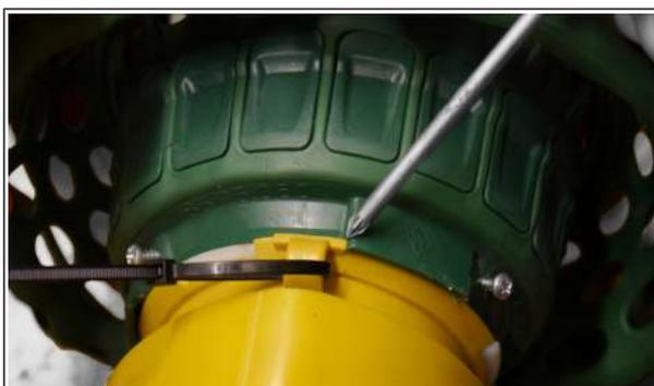
Положение внешней защитной - не зафиксирована
