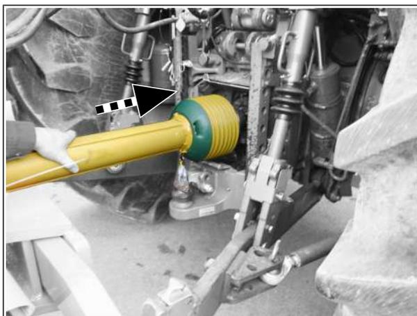
4. Надвиньте другую половину карданного вала на вал отбора мощности и заблокируйте зажим:
