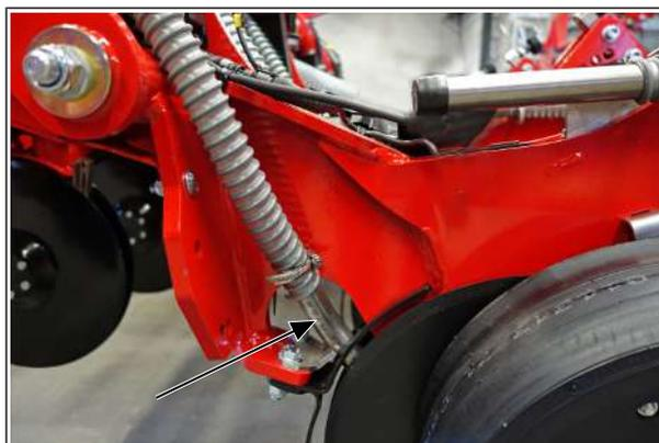
При наличии дополнительного оборудования гранулят можно укладывать на поверхность земли за прижимными роликами.
