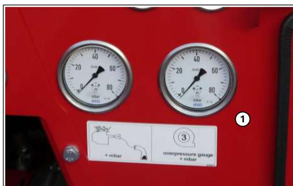
Манометр, избыточное давление
