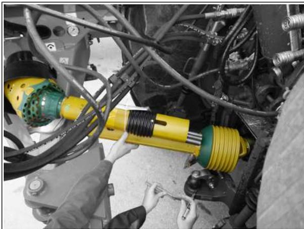
6. Отметьте внутреннюю защиту половины карданного вала. При минимальной рабочей длине расстояние до защитного конуса должно составлять не менее 40 мм:
