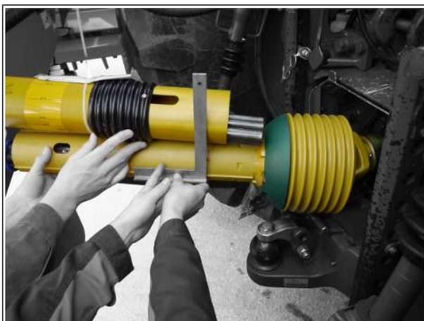
8. Позиционируйте машину относительно трактора так, чтобы была установлена максимальная рабочая длина карданного вала. Проверьте длину перекрытия карданного вала в этом положении. Длина перекрытия после укорачивания должна составлять не менее 200 мм.
