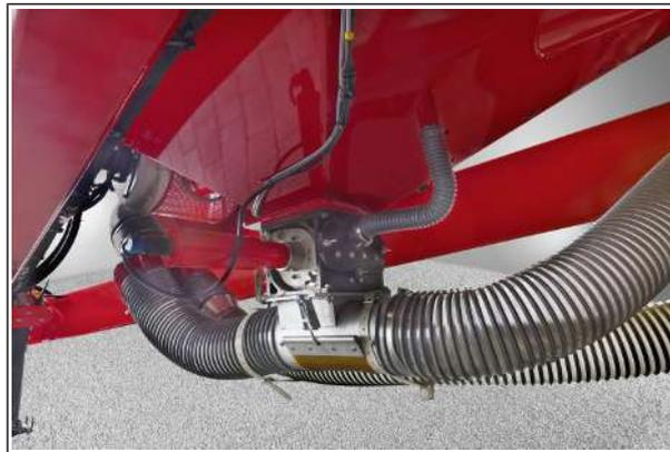
Дозатор со спускным шлюзом
