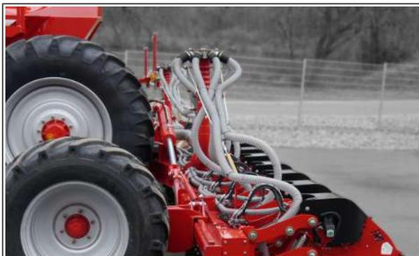
Башня распределителя с шлангопроводами системы внесения удобрений
