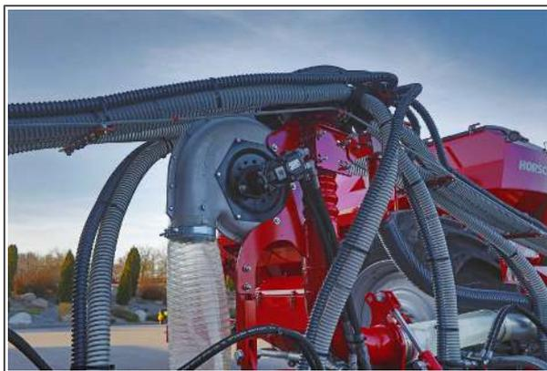
Воздуходувка избыточного давления
