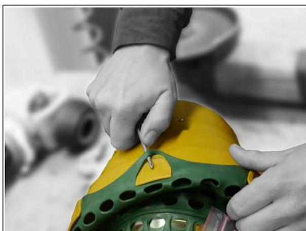
6. Поверните эластичный элемент и внешнюю защитную трубу в противоположных направлениях, чтобы разблокировать узлы:
