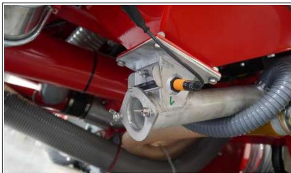
Бункер заперт, дозирующий шнек извлечен
