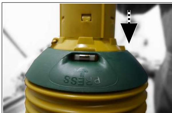
16. Надвиньте внешнюю защитную трубу вместе с эластичным элементом полностью на другую фасонную трубу:
