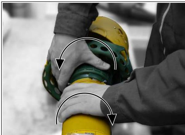
7. Снимите внешнюю защитную трубу вместе с эластичным элементом.
