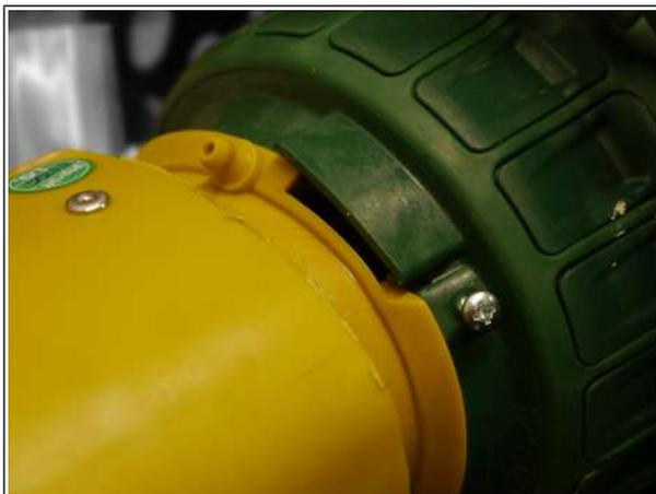
Положение внешней защитной трубы – не зафиксирована
