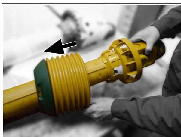
3. Снимите внутреннюю защитную трубу:
