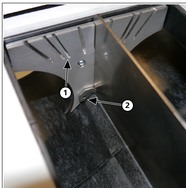
Замена разделительной перегородки
