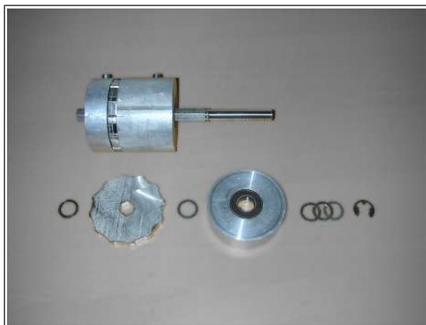
Пример: ротор для мелких семян, ячейковый диск (обратите внимание на необходимое количество ячейковых дисков, см. выше).
