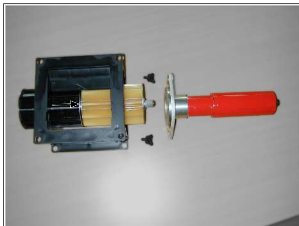
Замена ротора при полном бункере
