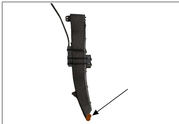
Спускная труба с начинающимся засором
