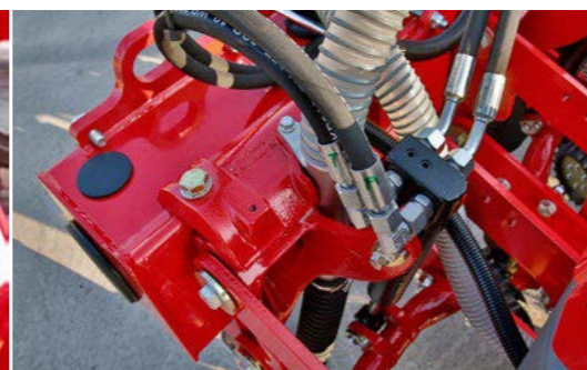
Крепежные направляющие для быстрого переоборудования с 12 на 8 рядов и серийные гидроцилиндры для доп. давления на секции
