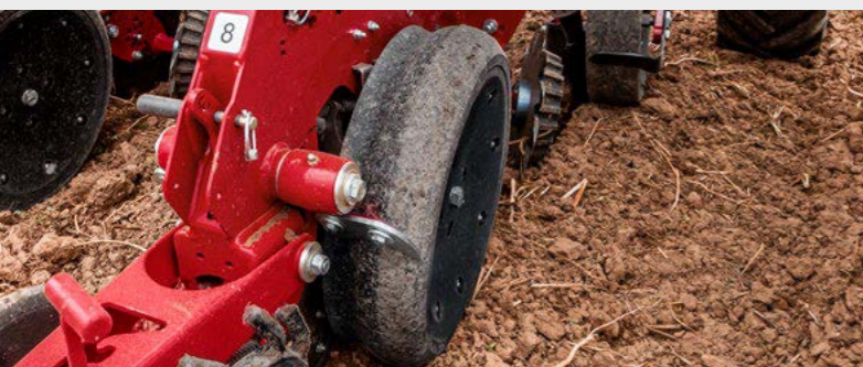
AutoForce датчик давления: для фиксации опорной нагрузки используется датчик Piezo (специальная технология определения веса).
