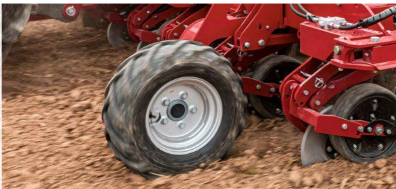
Опорный ролик для ведения по глубине Maestro RV/RX
