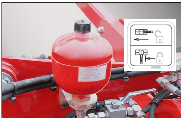
Гидроаккумулятор с запорным краном
