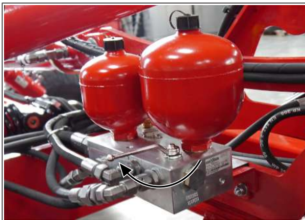
Запорный кран системы усиления тяги - положение "0"
