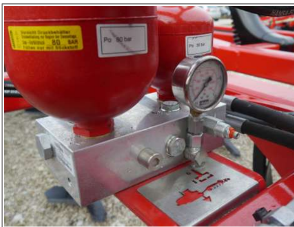
Гидравлический блок системы усиления тяги с табличкой с символом
