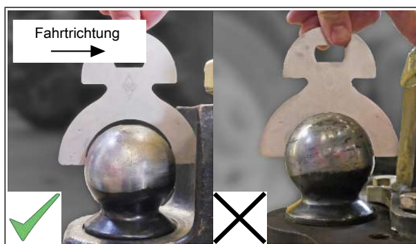
Проверка износа шара
