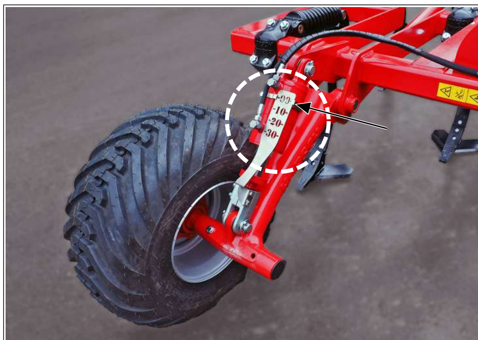
Гидравлическая регулировка глубины / индикация глубины на шкале
