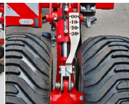
Настройка глубины хода лап при помощи алюминиевых упоров
