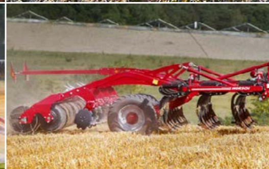
Маневренность вследствие шасси в центре машины
