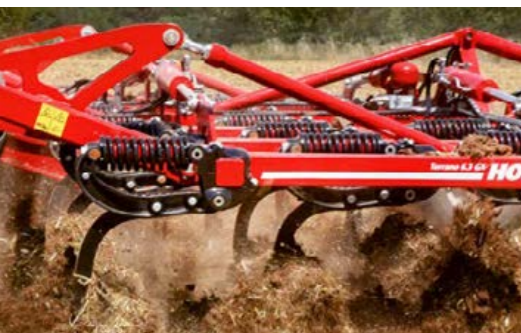
TerraGrip III с силой срабатывания 550 кг
