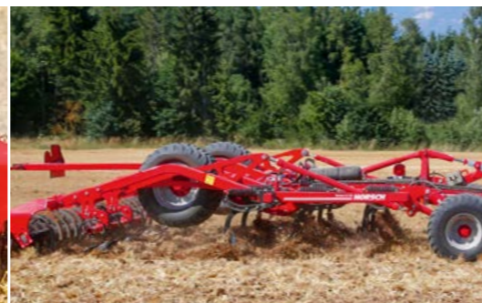
Компактная конструкция (положение колес шасси в поле)
