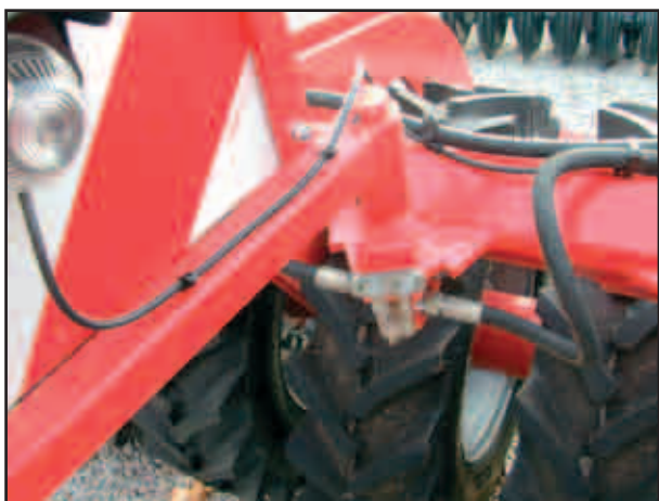
Кронштейн освещения с запорным краном
