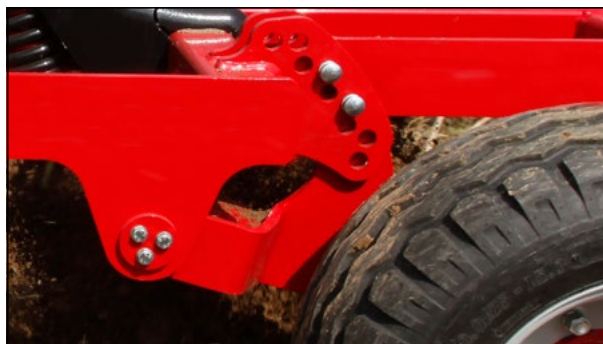
Опорное колесо Terrano 5 FX, палец в заднем ряду отверстий
