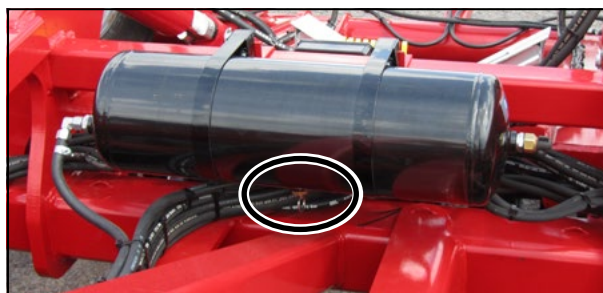
Воздушный ресивер с клапаном удаления воды
