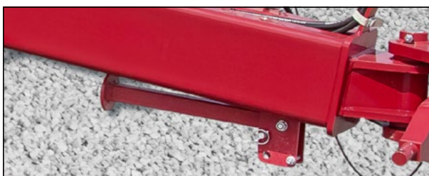
Выведенная вверх опорная стойка
