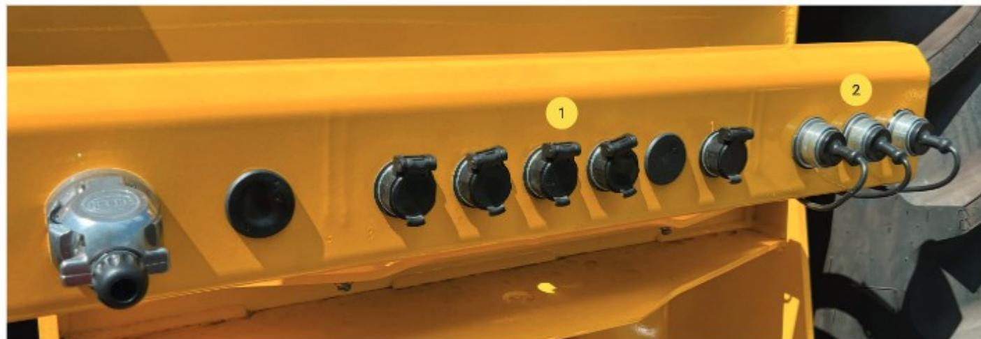
На серии Novo установлен один гидравлический насос с подачей 146 л/мин, который подает масло на три пары гидровыходов и муфту PowerBeyond. Гидровыходы так же, как и на BrioSo, обладают механическим управлением (одна пара с регулировкой по потоку).
