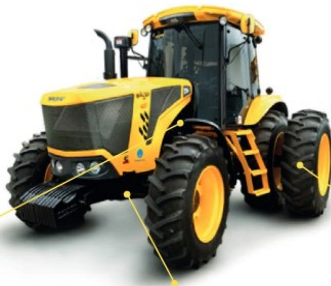
Топливный бак объемом 420 л позволяет работать весь день без дозаправки (до 12 ч).
